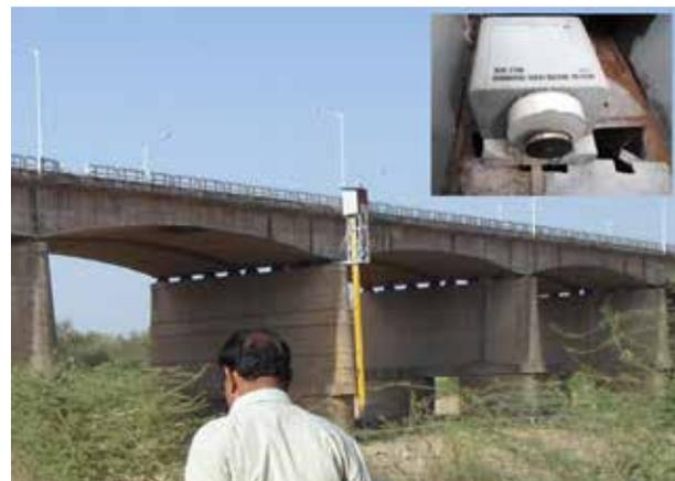
**FIG 3.10B:** A SHAFT ENCODER INSTALLED ON THE SIDE OF A BRIDGE IN GUJARAT
